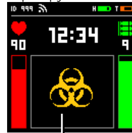
Сработал датчик отсутствия касания второй руки
