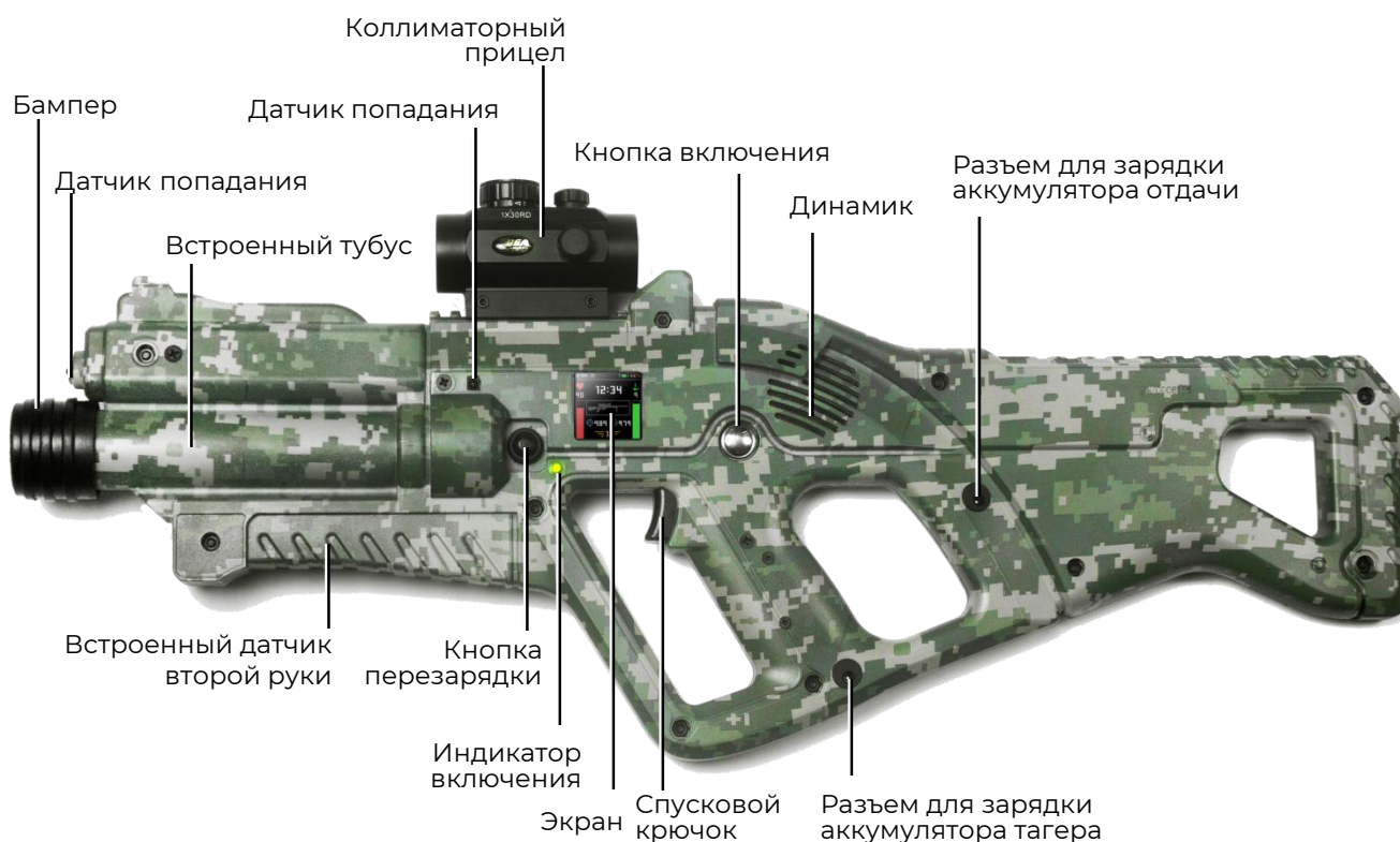
Основные элементы тагера на примере штурмовой винтовки Falcon F2* (в комплектации Tactical Pro)
