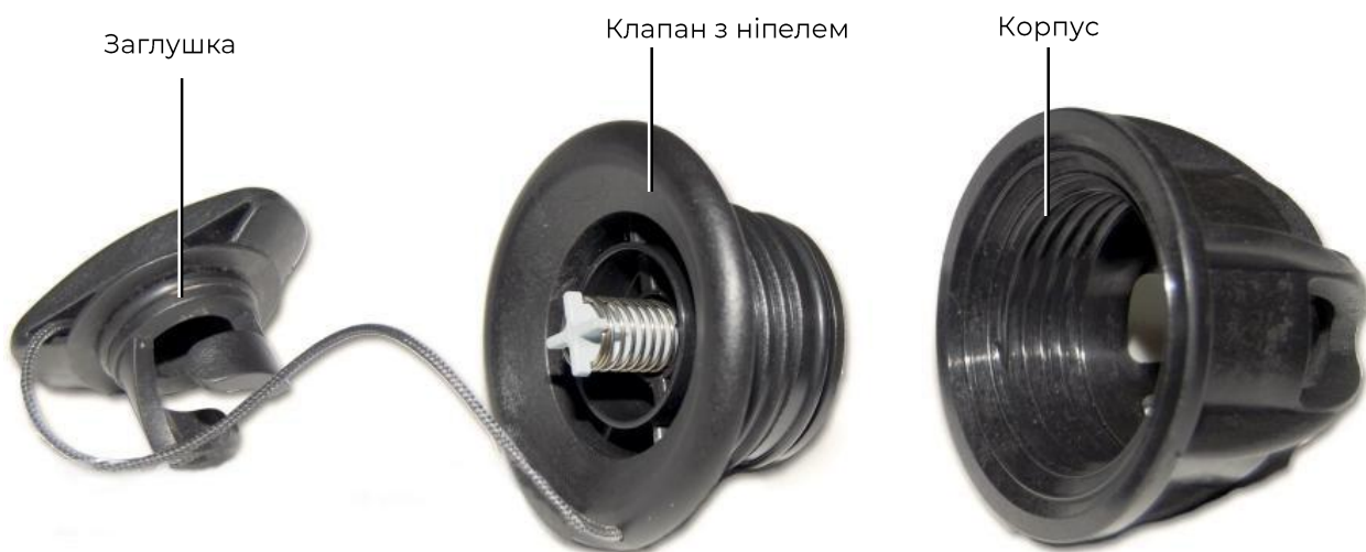
Конструкція ніпельного клапану
