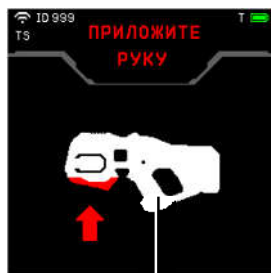
Спрацював датчик відсутності торкання другої руки
