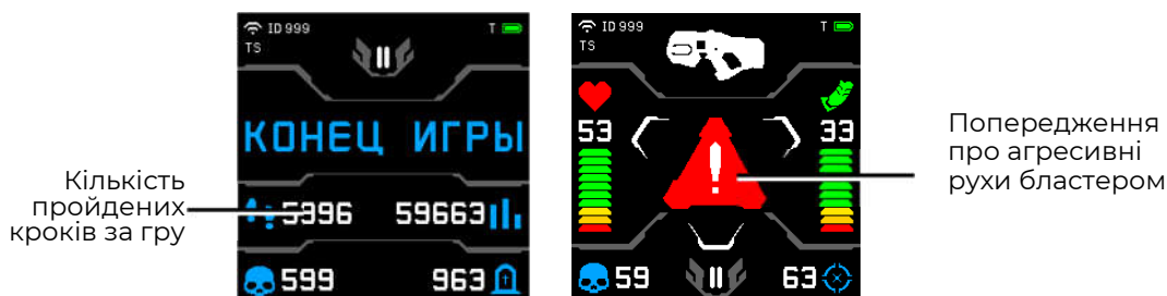
Результати роботи гіроскопа і акселерометра на екрані бластера
