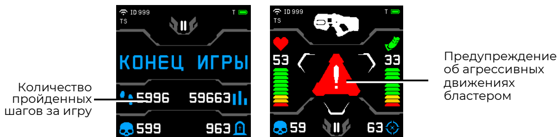
Результаты работы гироскопа и акселерометра на экране бластера
